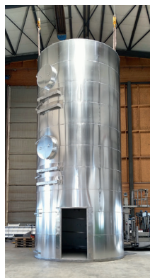
Tank med isolering
